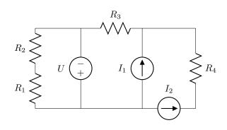
**2)** [4p] Kända:  $R_1, R_2, R_3, R_4, U, I, g, h.$
