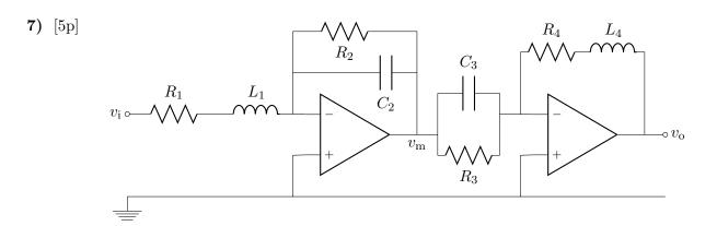
a) [2p] Bestäm nätverksfunktionen  $H(\omega) = \frac{v_o(\omega)}{v_i(\omega)}$  av kretsen ovan. Det kan hjälpa att räkna i två steg, med hjälp av den (okända) potentialen  $v_m$  i mitten av kretsen.
