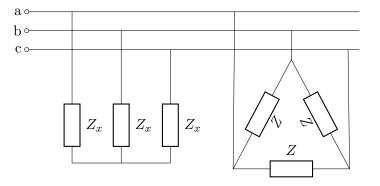
a) [2p] Vilken aktiv effekt och reaktiv effekt förbrukas av delta-lasten (de tre impedanserna Z)?
