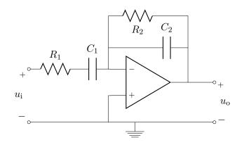
c) [2p] Skissa ett Bode amplituddiagram av funktionen  $H(\omega)$  från deltal 'b'. Anta att  $100 \omega_1 = \omega_2$ , och att  $\omega_2 \ll \omega_3$ . Markera viktiga punkter och lutningar.
