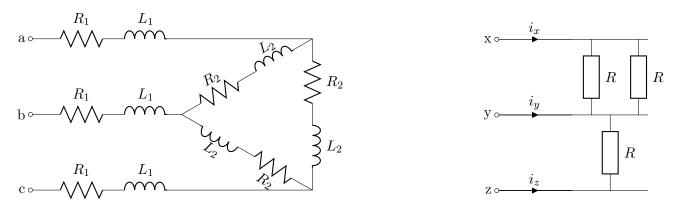
a) [2p] Kretsen till vänster modellerar en  $\Delta$ -last  $(R_2, L_2)$  kopplad till källan genom en kabel som har motstånd  $R_1$  och induktans  $L_1$ . Vilken effektfaktor (PF) matar källan, vid polera a,b,c?
