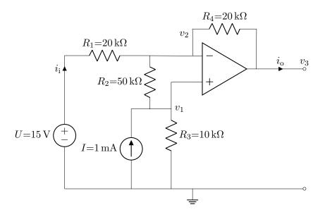
$v_1 = v_2 = 10 \,\mathrm{V}$  $v_3 = 5 \,\mathrm{V}$
