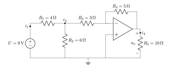
$v_a = 3 \,\mathrm{V}, \quad u_o = -5 \,\mathrm{V}, \quad i_1 = 1.5 \,\mathrm{A}, \quad i_4 = -0.5 \,\mathrm{A}, \quad R_i = 6 \,\Omega$
