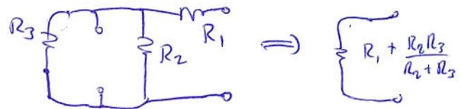
$$R_T = R_1 + \frac{R_2 R_3}{R_2 + R_3} = \frac{R_1 R_2 + R_1 R_3 + R_2 R_3}{R_2 + R_3}$$
